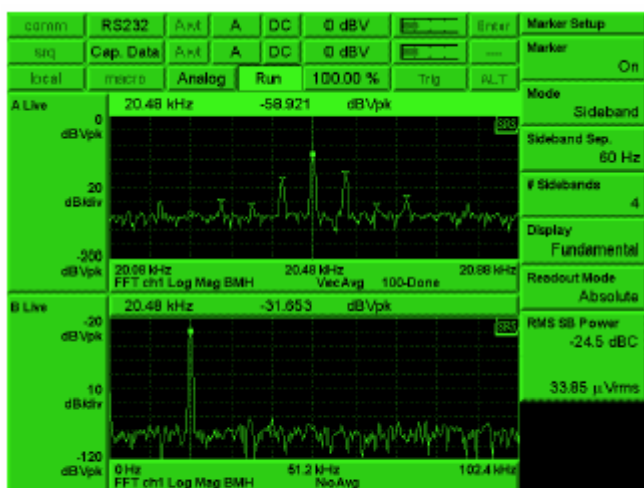
窄带FFT (上图), 宽带FFT (下图)
